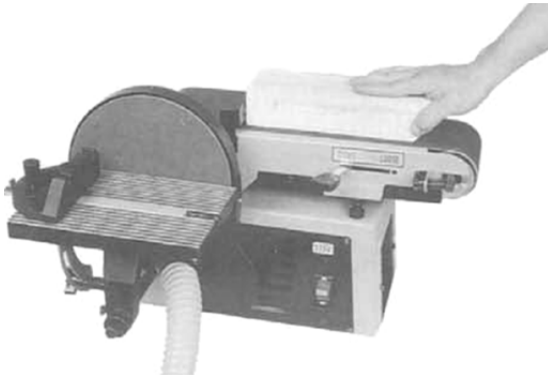
Figure 9-2: Ponçage à plat
